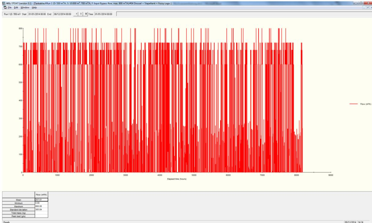
Abb. 38: Works #04, Run 1, Volumenstrom im Tankablauf als Ergebnis der Fuzzy-Regelung
