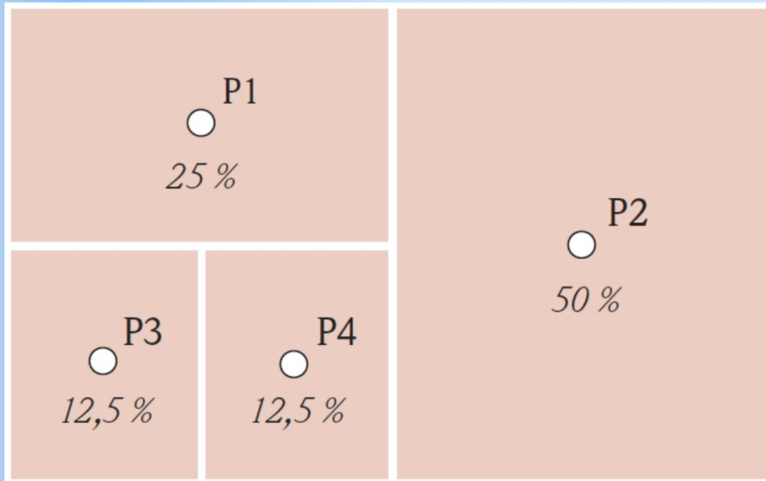
Die Größe der zu untersuchenden Fläche beträgt 750 m<sup>2</sup>. Die Fläche ist mit Blei (Pb) kontaminiert. Vier Bodenprofile (P1 bis P4) liegen vor. Die Flächenrepräsentanz R der Bodenprofile ist kursiv angegeben [%].
